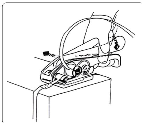
6. Pressione a alavanca de tensão para cortar a fita, com a alavanca de tensão pressionada, gire o aparelho para a direita e remova-a da fita finalizada.
