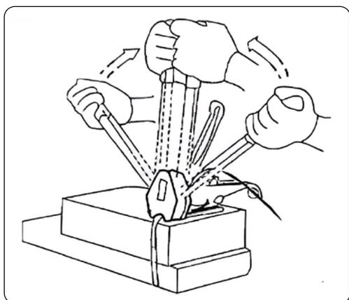
5. Abra o selador completamente, coloque o selador no topo do selo, pressione a alavanca para selar totalmente o selo, remova o selador.
