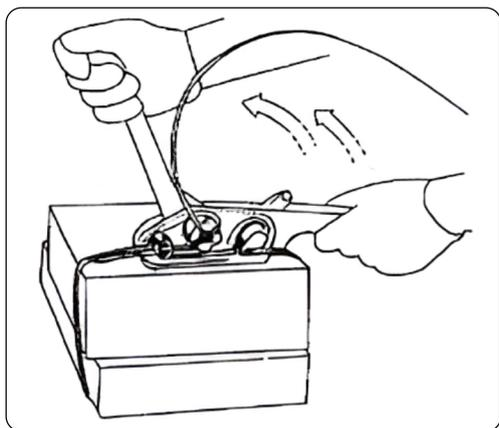
3. Segure o aparelho com a mão esquerda e mova a alavanca para frente e para trás com a mão direita, até que a fita esteja tensionada.
