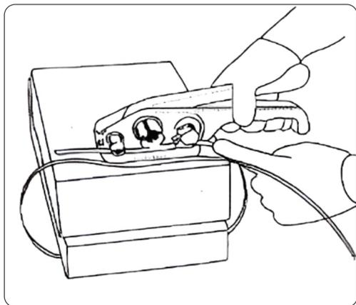
1. Coloque a fita ao redor do pacote como mostrado, segure o esticador com a mão direita e pressione a alavanca de tensão, passe a fita pelo aparelho, a extremidade da fita deve se projetar além do aparelho, solte a alavanca de tensão.
