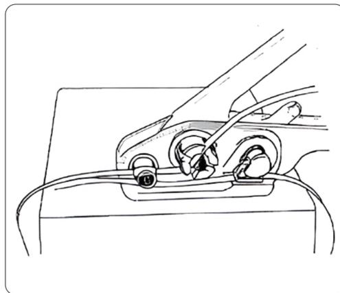
2. Deslize a parte superior da fita no slot do cortador e no slot do molinete.
