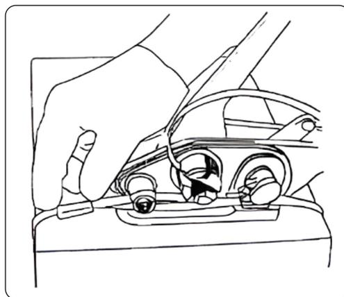
4. Quando a tensão adequada for alcançada, coloque o selo com o lado aberto para baixo sobre ambas as fitas na frente do aparelho.
